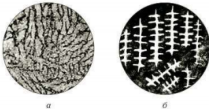
Рис. 1. Микроструктура латуни: а — микроструктура двухфазной латуни после обработки давлением; б — эскиз микроструктуры латуни марки Л70
