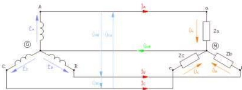
Рис. 1 Соединение фаз трёхфазной цепи звездой
